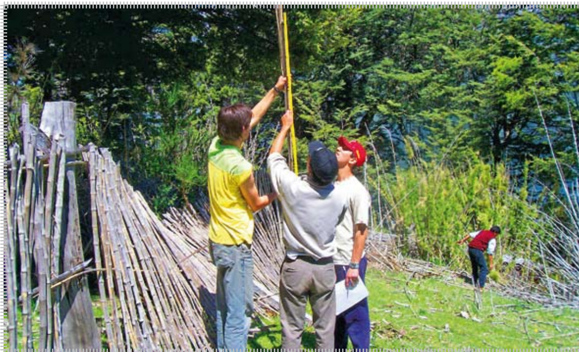
En la casa de un poblador del lago Huechulafquen, alumnos de 6to. año de la EPET N° 4 miden la altura de un salto de agua por el método de la manguera de nivel.
