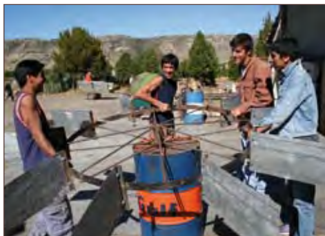
Preparación de una turbina a hélice para ser instalada en la casa de Elsa Cañicul, en el lago Huechulafquen.
